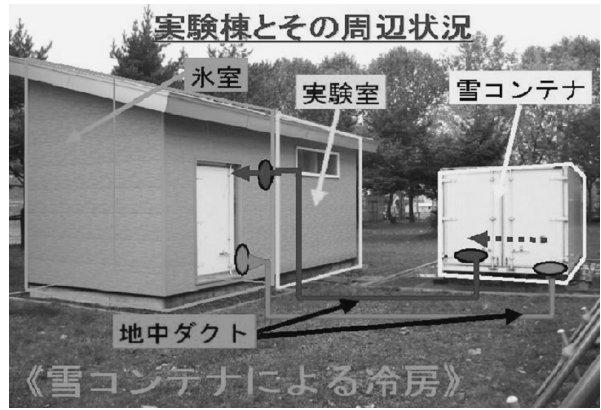
図Ⅳ-3 貯雪による冷房の概要
