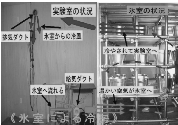
図Ⅳ-2 氷室による冷房の概要
